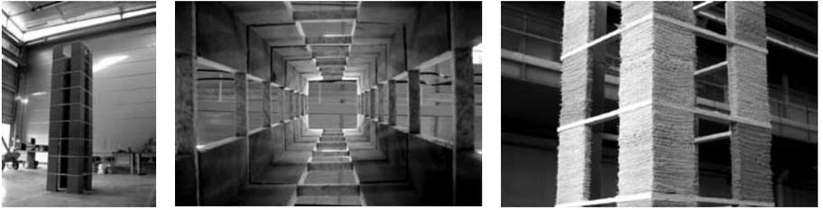
Figure 12 Tour de sable compacté armé. Les murs ont une épaisseur de 4 cm pour une tour de 3 mètres de haut. L'image de droite, la surface a été frottée pour laisser apparaître des armatures placées entre les couches de sable compactées.
