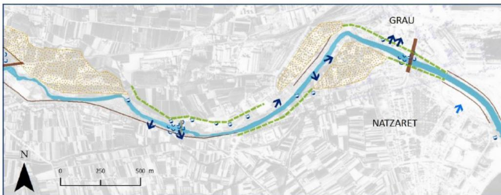
Fig.080. Comportamiento hidráulico del encauzamiento durante la riada de 1957.
