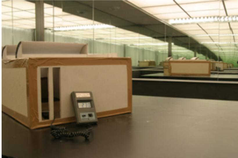
**Figure : Simulateur de lumière diffuse (ciel artificiel), ENSAG.**
