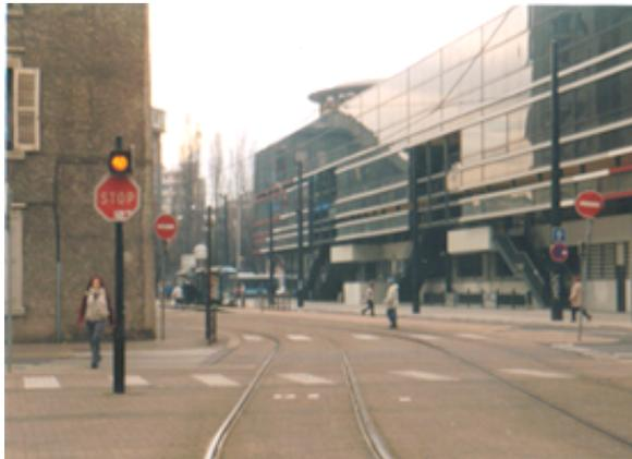
Le partage de la voie entre les différents utilisateurs est peu lisible. Les véhicules passent de chaque côté de la plate-forme et dans le même sens. Les voitures roulent sur le trottoir et sur un refuge pour piétons. Cette situation entraîne la pose de nombreux potelets, sans pour autant résoudre les problèmes
