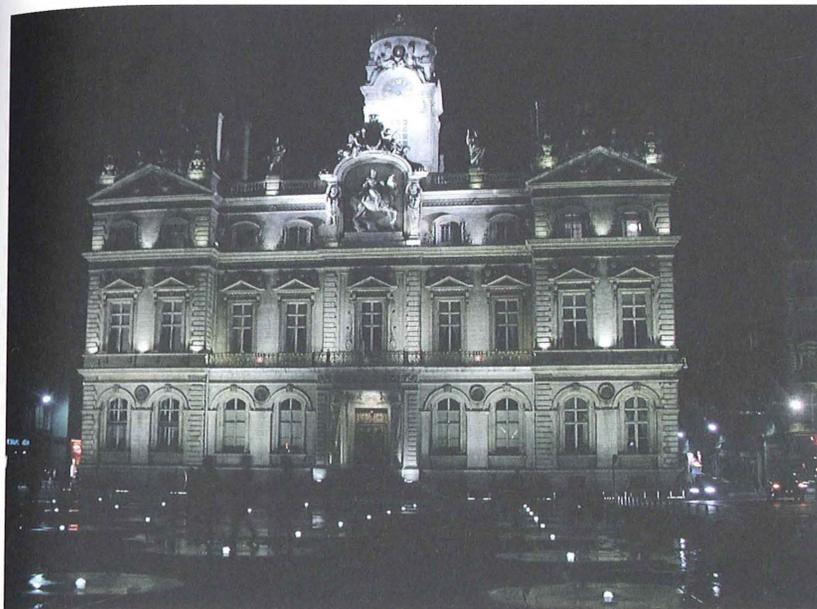
*Illustration 2 – Place des Terreaux, éclairage indirect par illumination des façades et trame de fontaines lumineuses au sol. (© UMR CNRS 1563)*
